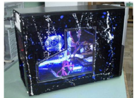
Vista lateral com a janela em acrílico a mostrar o interior do computador
